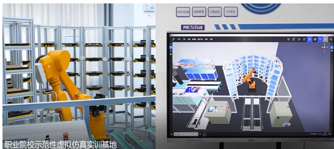
图 2 开发的数字孪生的教学资源(仓储自动化单元)
